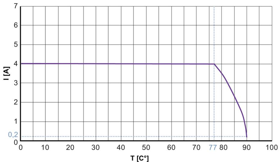
Снижение мощности  $I_{max} * 0.8$  (DIN EN 60512-5-2)
